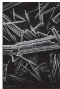
図5 静置晶析による束状晶
