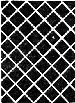
のティツシュを白線スクリーンに密着して再び焼付を行ふ。白線スクリーンとは挿圖に示す如く不透明なる硝子板上に縦横に交叉せる透明線を引けるもので 1 cm に 60~70 の線を有するを普通とする。焼付によつてティツシュの膠膜は陽畫の各部を通して來る光量に比例して不溶解性となる。
